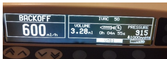
Slika 7: Razbremenitev linijskega tlaka.
