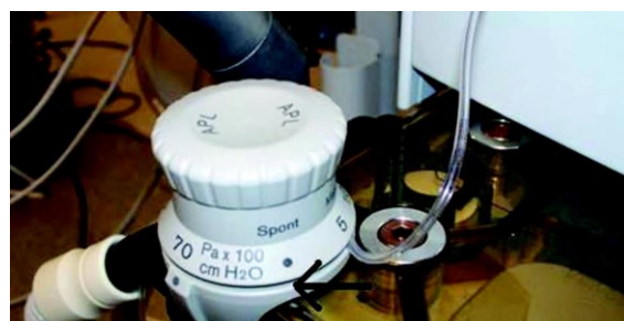
Slika 5: Ujetje cevke v razbremenilnem ventilu.
