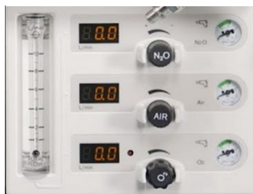
Slika 5. Aparat Dräger Fabius Tiro z elektronskimi pretočnimi merilniki ter rezervnim analognim merilcem pretoka svežih plinov.
