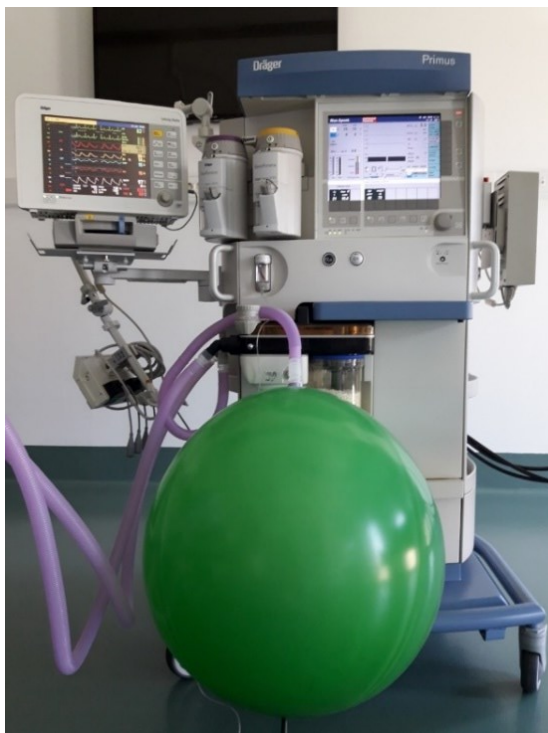
Slika 8: Varovalna funkcija anestzijskega dihalnega balona (levo) in dinamična sprememba tlaka v balonu med njegovim polnjenjem.
