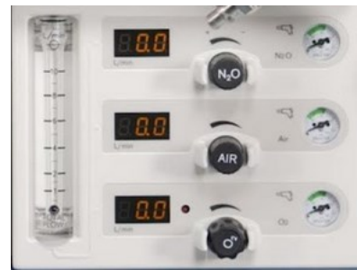
Aparat Dräger Fabius Tiro z elektronskimi pretočnimi merilniki ter rezervnim analognim merilcem pretoka svežih plinov
