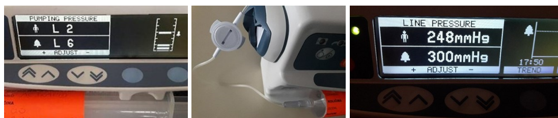
Slika 6: Tlak bata brizgalke (levo), membrana (sredina) in linijski tlak (desno).
