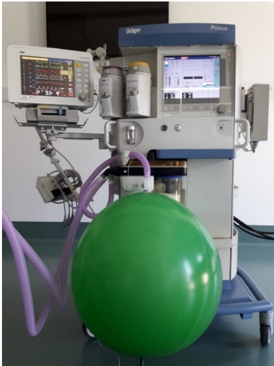
Slika 8: Varovalna funkcija anestezijskega dihalnega balona (levo) in dinamična sprememba tlaka v balonu med njegovim polnjenjem.
